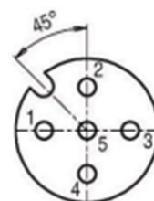
Рис. 13 Схема соединений штекера UFM 200
